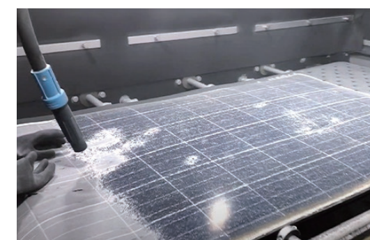
太陽光パネルのリサイクル処理設備
